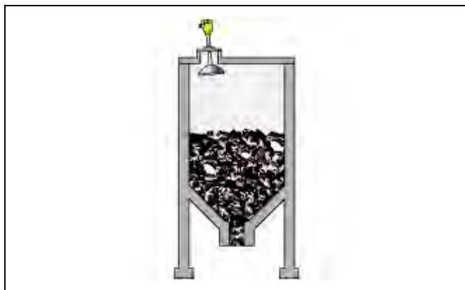
Рис. 7: Измерение уровня в силосе с клинкером с помощью VEGAPULS 68
